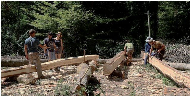
Équarissage de grume à la hache : façonnage de poutre de charpente.
