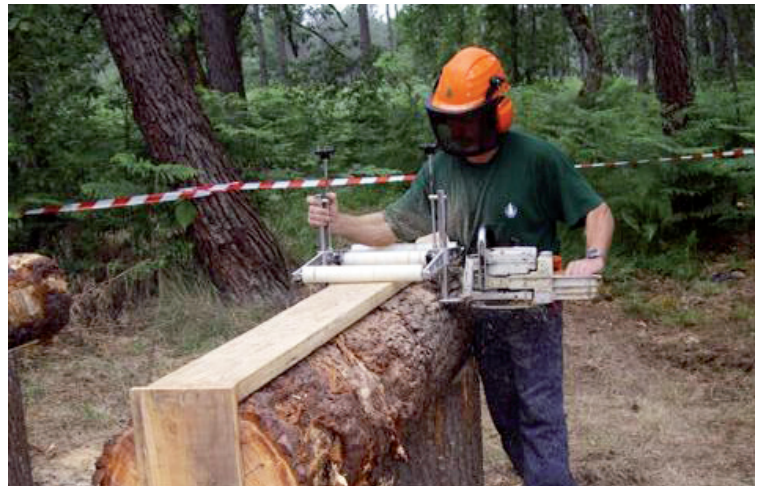
Gruminette ou scie portative : matériel léger pour fabriquer ses planches en toute autonomie.
